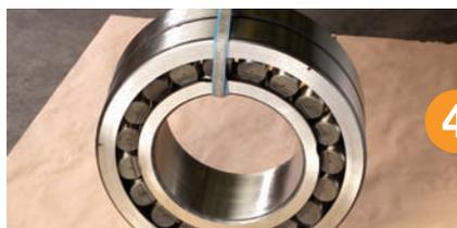
Cuando el rodamiento esté en posición vertical, colóquelo con cuidado sobre una superficie limpia. Muévelo muy despacio, los rodillos que se encuentran en la parte de abajo están soportando todo el peso del rodamiento.
