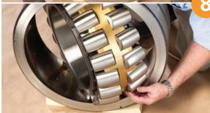
Los rodamientos esféricos grandes con rodillos pesados (serie 232 con más de 320 mm de diámetro interior) deben cerrarse entre dos personas. Los rodillos de la parte baja del ensamble pueden salirse de su posición. Estos rodillos deben ser sostenidos y guiados con las manos hacia su posición, mientras se cierra el rodamiento lentamente. Si al cerrar el rodamiento, empuja los rodillos hacia su posición con la fuerza y el peso del ensamble, puede causarse rozamiento e incluso brinelado.
