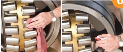
Para reducir la posibilidad de rozamiento entre las superficies durante la inspección, mantenga los puntos de contacto de los rodillos y la pista exterior bien lubricados. Reduzca la cantidad de apertura o rotación del anillo interior y el ensamble de rodillos sobre la pista exterior del rodamiento.
